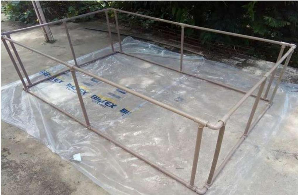
Figura 8: Modelo ilustrativo da tenda elaborada com tubo em PVC e lona plástica
